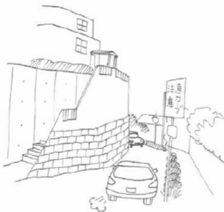
急カーブなのにせっかくの視界を遮る高い垂直よう壁。危ない！夏は暑い！自分の家は眺めが良くなっても週りに不快を与えないよう、文脈を読んで住まいをつくろう。
